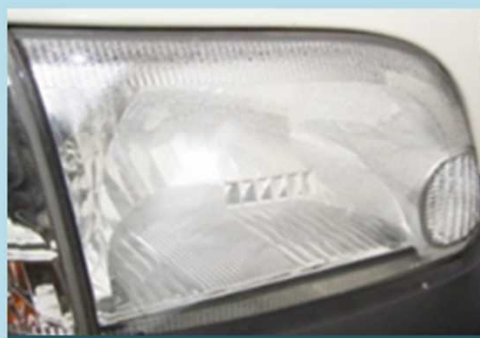
内部リフレクタの劣化
